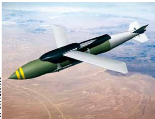
FOT. 5. Australijska bomba szybująca JDAM-ER łączy usterzenie JDAM ze skrzydłami Hdh/DSTO
