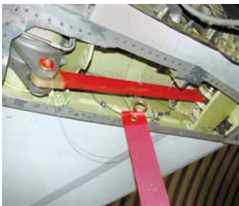
FOT. 3. Sposób zablokowania lewego statecznika samolotu F-16 Block 52+. Unieruchomienie steru spełnia wszystkie wymagania bezpiecznego stosowania tego rodzaju zabezpieczeń w samolotach F-16
