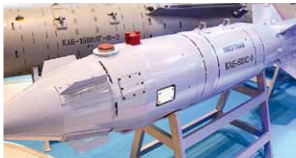
FOT. 3. Rosyjska bomba kierowana KTRV/GNPP KAB-500S-E
